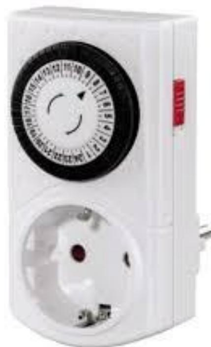
**Se configura la hora y se programa los tiempos de encendidos bajando unas pestañas y los de apagados subiendo las pestañas.**
