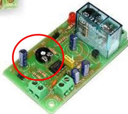
**Temporizadores On-Delay y Off-Delay con variación del tiempo mediante resistencias ajustables.**
