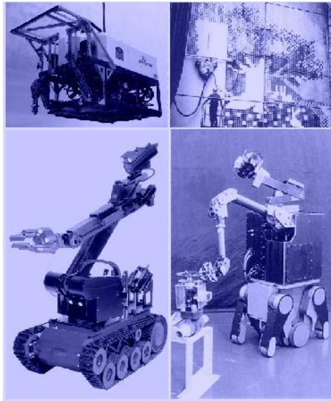
Ejemplos de robots de servicio: robots subacuáticos; robots escaladores; robots contra incendios y bombas; robots para manejo de material nuclear
