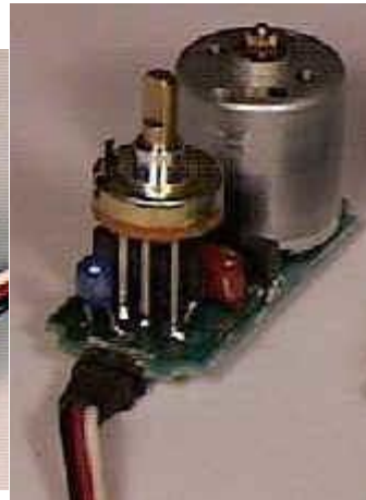
Detalle del circuito de realimentación
