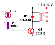
En este caso, la salida del divisor de tensión está en el cursor del potenciómetro, al iluminar la foto celda se alimenta la base del transistor y este pasa a plena saturación.
