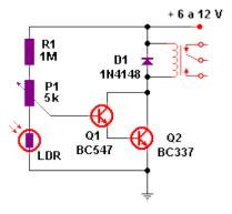
En este esquema puedes ver los transistores en Darlington, es con la idea de aumentar la ganancia del circuito y obtener un corte más profundo en el divisor de tensión, el tema es que con este último circuito el relé se mantiene inactivo siempre que haya iluminación en la LDR, y cuando esta iluminación se interrumpe se acciona el relé.
