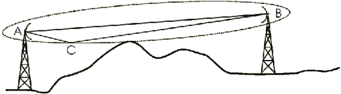
Fig. 4.23. Elipsoide de Fresnel para un radio enlace
