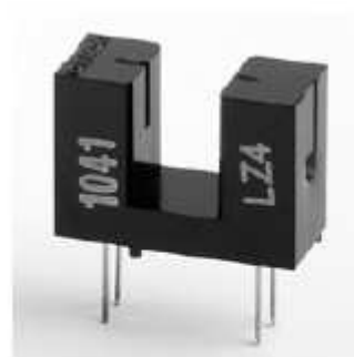
Optotransistor de encapsulado ranurado tipo Camello
