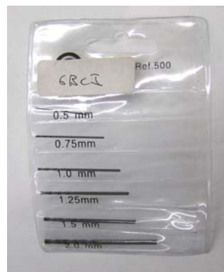
Figura 3.2: Juego de brocas para electrónica
