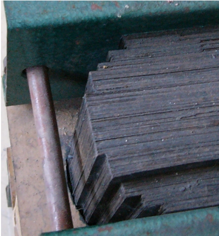
Fig. 4: Detalle de la columna de un transformador trifásico
