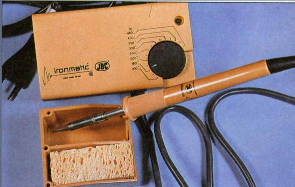
□ Conjunto completo de soldador con control de temperatura. Esta puede ser ajustada mediante un botón selector. También dispone de aislamiento de la red, con toma de tierra.
