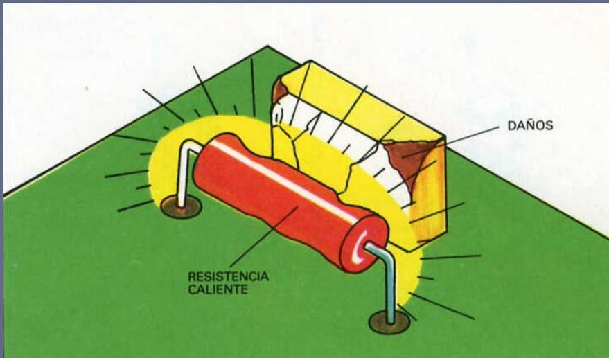
❑ La separación, entre componente y PCI, es recomendable para disipar el calor, siempre que lo requiera el tipo de componente para garantizar su correcto funcionamiento.
