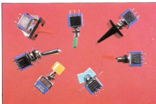
Conjunto de llaves conmutadas de dos posiciones, con modelos accionados por palanca, llave de bajo relieve o pulsador.
