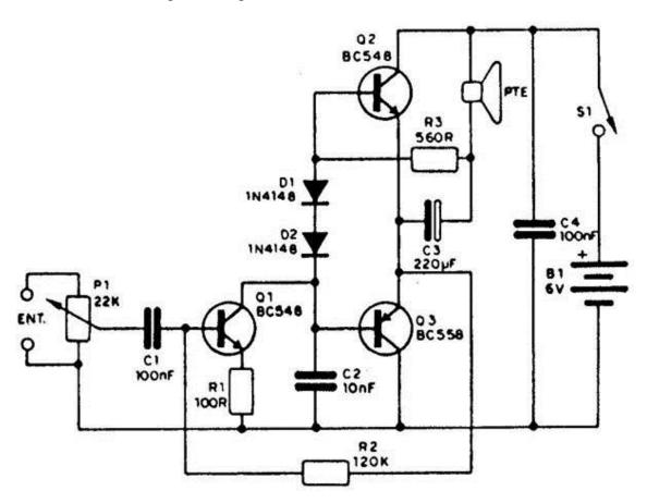
Se trata de un amplificador de tres transistores, que puede usarse como etapa de salida de radios, sirenas o como amplificador de prueba.
