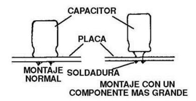
Si no podemos contar con las informaciones sobre la dimensión de todos los componentes, es conveniente por lo menos estandarizar la separación de terminales para los más usados, y hacerlo con un margen de seguridad que no comprometa el funcionamiento del circuito.
