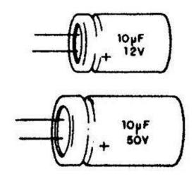
En los catálogos de los fabricantes hay tablas en que encontramos información que relaciona las dimensiones de los componentes y separación de los terminales conforme a su valor.
