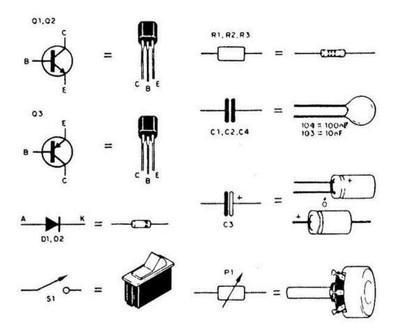
Para las resistencias de 1/8W, por ejemplo, si queremos montarlos horizontalmente, tendremos que separar los agujeros en la placa por lo menos 8 mm. Si un condensador electrolítico tuviera terminales paralelos, la separación debe ser verificada antes y será menor que en el caso de uno que tenga terminales axiales (figura 8).
