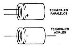
Está claro que el montaje de los dos tipos se hace de modo distinto, si bien existen ocasiones en que uno puede ser usado en lugar del otro, como se muestra en la siguiente figura.
