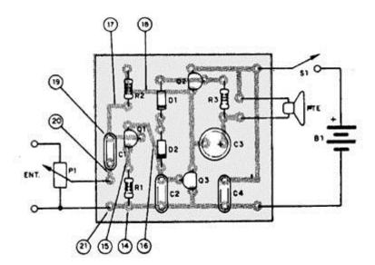
Vea que el mismo conecta la base de Q1 con la juntura de los dos emisores de los transistores Q2 y Q3. En el diagrama esta resistencia pasa "por fuera", pero en la placa tenemos una posibilidad interesante. Partimos de la base de Q1, para arriba, y pasamos la conexión a los emisores por debajo de D1. Esta conexión se muestra con el (17) y el (18).
