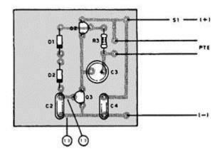
Ahora le toca al transistor Q1. Observamos que el mismo tiene en su emisor una resistencia (R1). Lo colocamos, entonces, según muestra la figura 13, con la resistencia junto al emisor, haciendo las conexiones (14) de la resistencia a la alimentación negativa; (15) de la resistencia al emisor de Q1 y (16) del colector de Q1 a la base de Q3. Tenemos ahora que pensar un lugar para R2 y también para C1. Comenzamos por R2.
