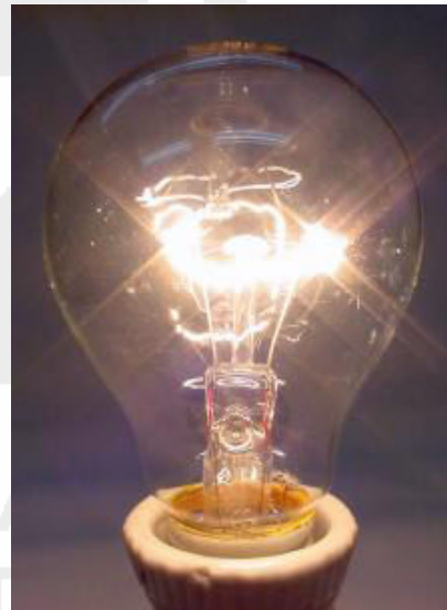
Filamento de tungsteno en espiral, en atmósfera gaseosa
