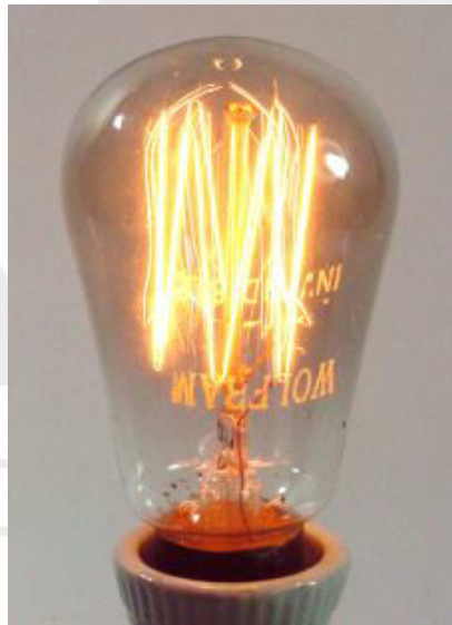
Filamento de tungsteno estirado, en vacío
